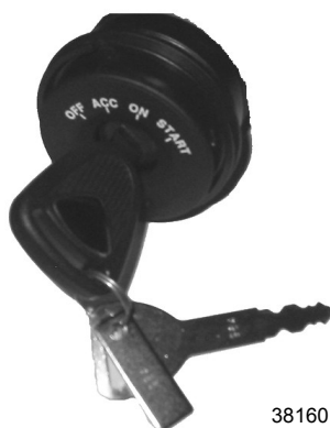
Clé de contact d'allumage à quatre positions
